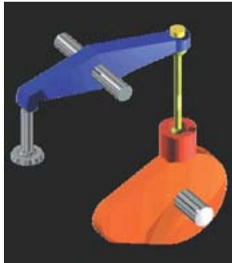
A rocker using a cam.
